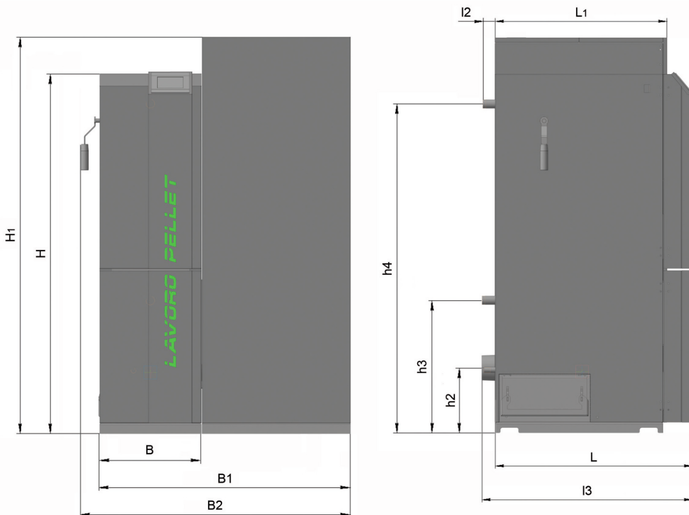
Рисунок 1. Габаритные и присоединительные размеры Котла LP-37
