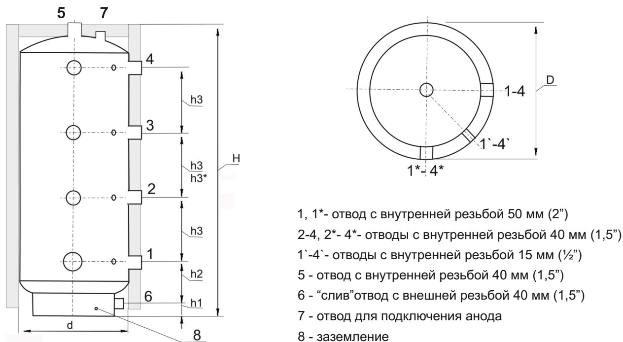
Рисунок 1. Схема подключения теплоаккумулятора серии ТА
