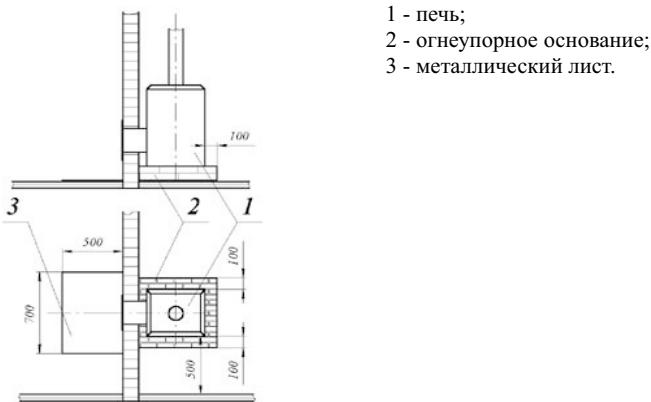
Схема монтажа дымохода из труб
