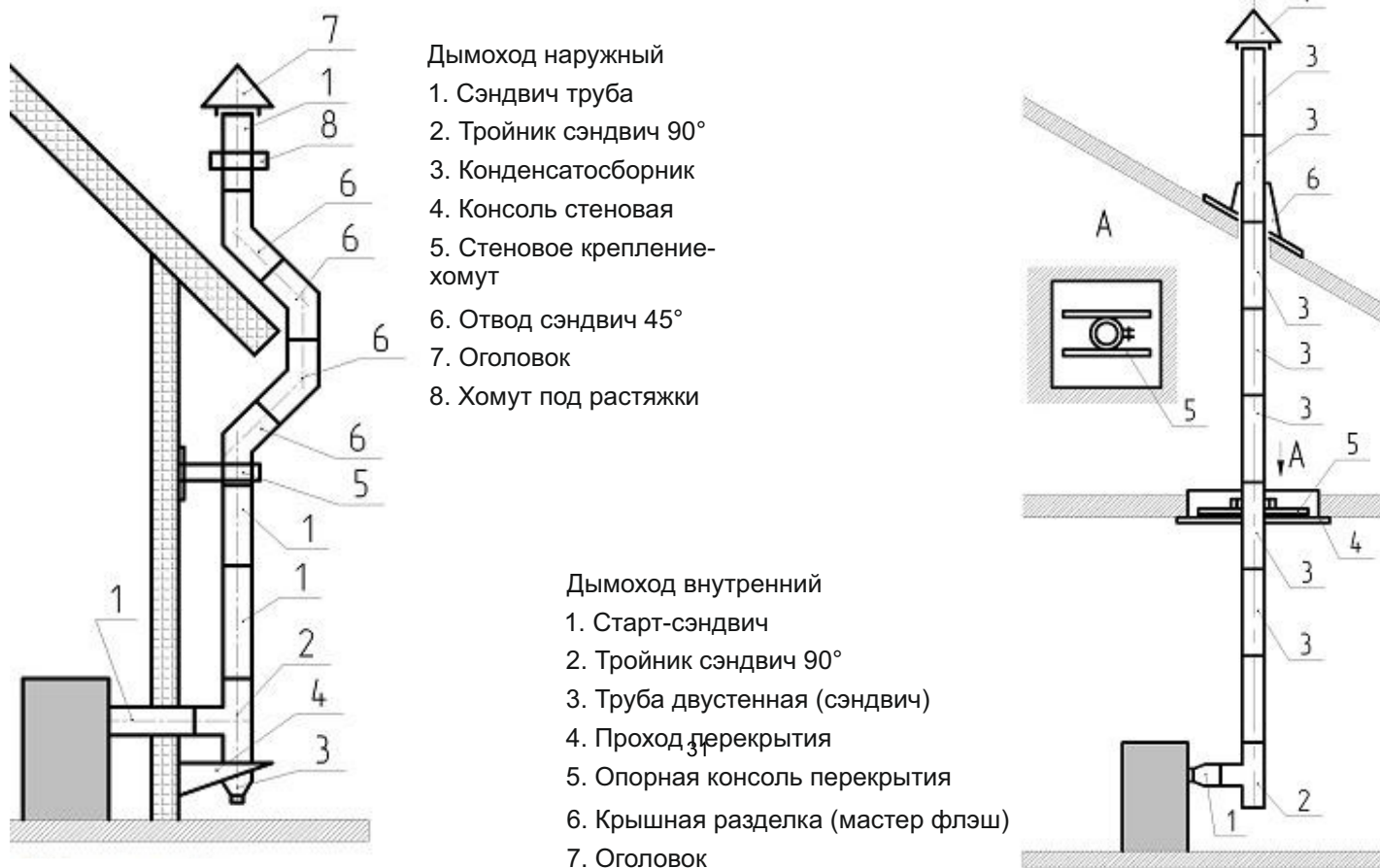
Рисунок Б.1. Пример сборки утепленного (сэндвич) дымохода по конденсату внутри и снаружи помещения
